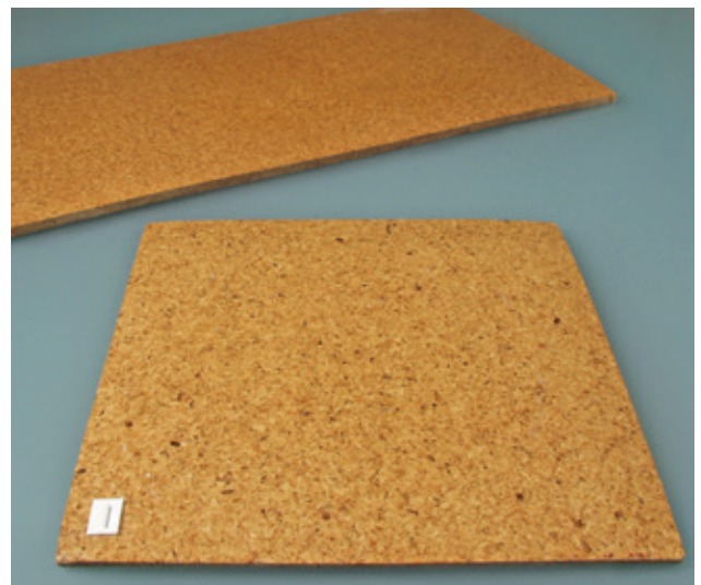
Figura 8. Plancha de corcho para soporte de estructuras a intervenir.
