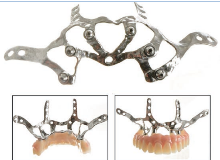
FIG. 13. Implante subperióstico de Ti-6Al-4V, y prótesis provisional de PMMA.
